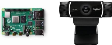
그림 1. 실험에 사용된 하드웨어(라즈베리파이 4B, 로지텍 웹캠 C922)
