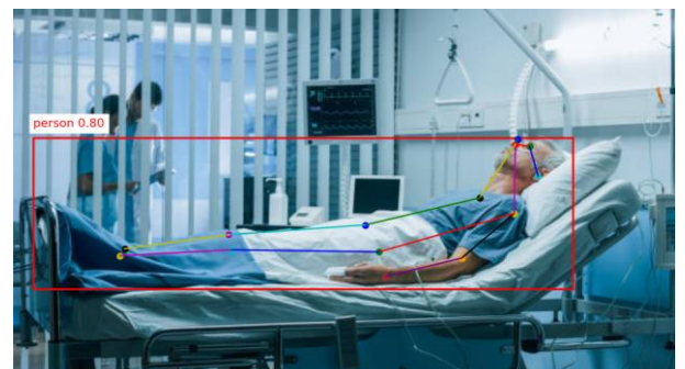
그림 1: YOLOv8 모델을 사용하여 환자의 자세 및 키포인트를 실시간으로 감지결과
