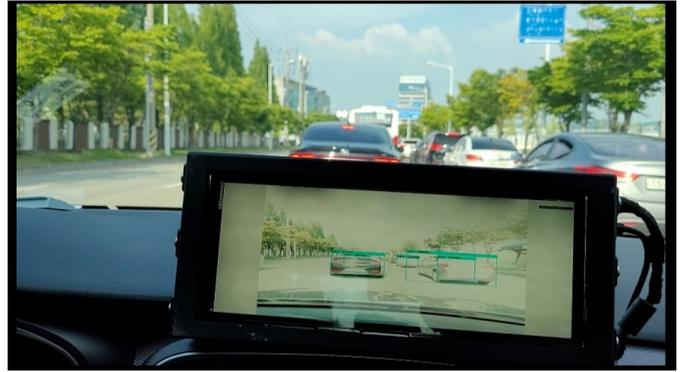
그림 6. YOLOv4-tiny 실 주행 적용 결과
