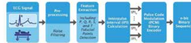
ECG 신호 분석 및 n-bit binary sequence 생성 과정
