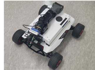
그림 1. 비접촉 차륜 프로파일 측정을 위한 제안 로봇 플랫폼
