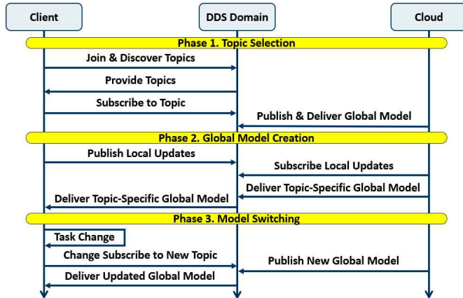
그림 2 DDS 기반 실시간 FL의 통신 흐름
