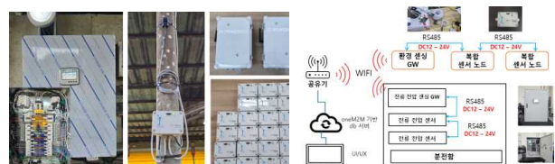
<그림.1 축사 내 POE 기술 기반 IOT 플랫폼 설계 및 구축>
