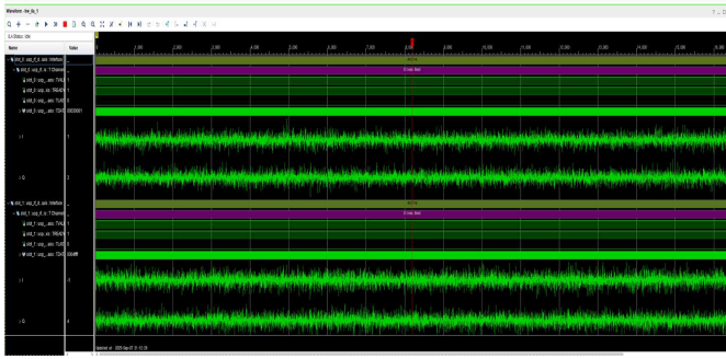
그림 3. NCO 2.20001GHz일 때, ADC 출력파형(위), DAC 입력파형(아래)
