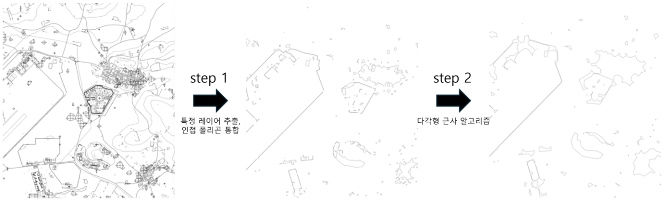
그림1. 압축 순서에 따른 지형 데이터의 변화. (좌측) 10개의 레이어가 포함된 공간 데이터. (중간) 10개의 레이어 중 1개 레이어(구조물)만을 추출하고 인접한 레이어 통합. (우측) 다각형 근사 알고리즘을 통해 각 폴리곤 표현에 필요한 포인트 수를 줄임.
