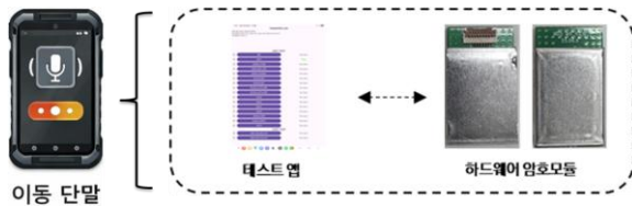
그림 4. 하드웨어 양자 보안 모듈 형상과 이동단말 App 테스트 시험 환경 구성의 실시에
