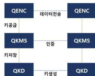
그림 1 QKD 기반 양자암호통신 구조
