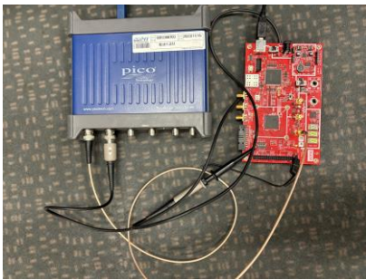
그림 3. CW305 보드와 picoscope 3403D 를 연결한 실험 세팅 사진
