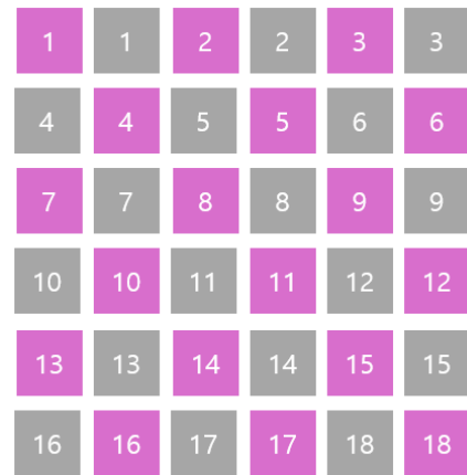
그림 1. Checkerboard 아키텍처 상 logical qubit 배치
