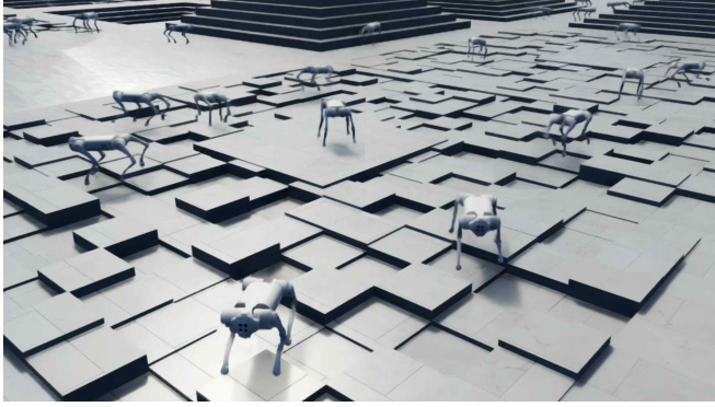
[그림 1] NVIDIA IsaacLab에서 로봇 보행 제어를 학습하는 모습
