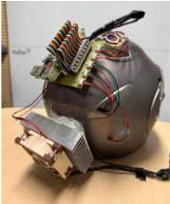
[그림 3] 스마트 헬멧 제작 결과
