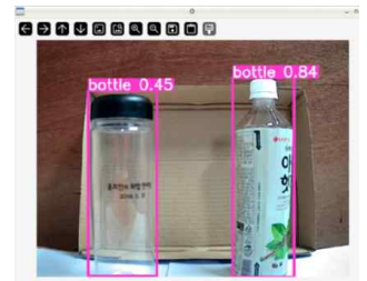
그림 2. Jetson Nano에서 YOLOv8 추론 실행 결과 화면
