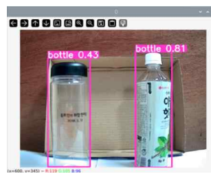
그림 1. Raspberry Pi 5에서 YOLOv8 추론 실행 결과 화면
