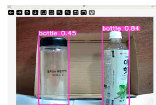
그림 3. LattePanda 3 Delta에서 YOLOv8 추론을 실행한 결과 화면
