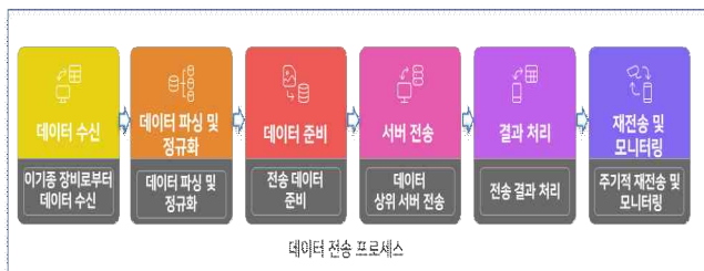
그림 2. Storage/Application Layer 데이터 전송 프로세스 Fig 2. Storage/Application Layer Data Transfer Process
