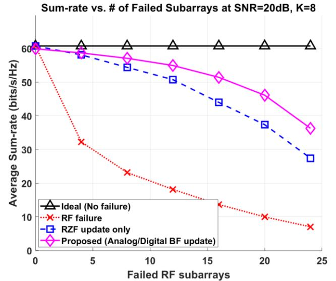
아날로그 위상 복원과 최소제곱 보상을 추가함으로써, 동일 조건에서 약 53 bits/s/Hz(원래 성능의 87%)까지 회복하며 RZF 업데이트만 적용한 경우보다 3-5 bits/s/Hz 추가 이득을 제공한다. 이를 통해 제안 기법이 심각한 RF-체인 고장 상황에서도 시스템 용량을 효과적으로 유지할 수 있는 것을 확인할 수 있다.
