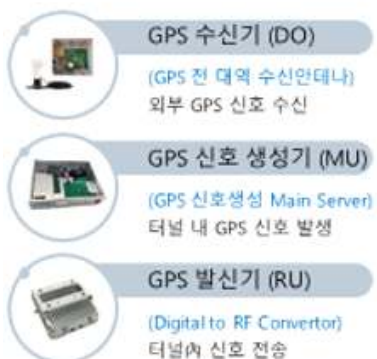
그림1. 터널내 GNSS 시스템 구성 및 결과
