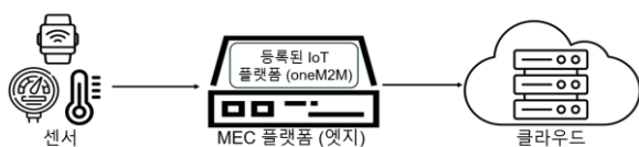
그림 1 - MEC 에 등록된 IoT 플랫폼, 디바이스 연동 구조
