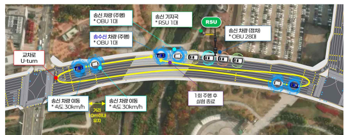
그림 1. 실 도로 환경에서의 혼잡 환경 동시 접속 시험 시나리오
