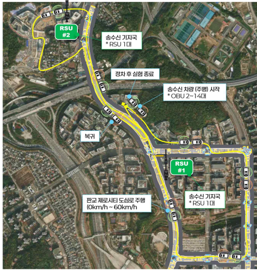
그림 2. 판교제로시티 실 도로 동시 접속 시험 시나리오
