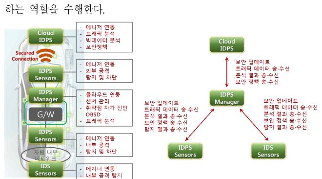
그림 1 IDPS 시스템의 구조
