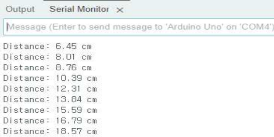
그림 3. 초음파 감지 센서에 감지된 물체의 거리
