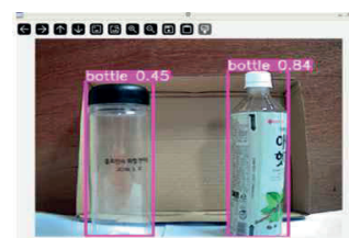
그림 3. LattePanda 3 Delta에서 YOLOv8 추론을 실행한 결과 화면
