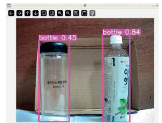
그림 2. Jetson Nano에서 YOLOv8 추론 실행 결과 화면
