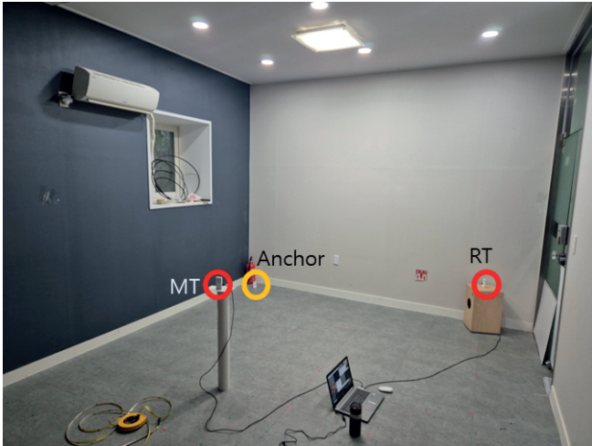
[그림 2] 실험 환경 내 앵커 및 태그(참조, 이동) 배치
