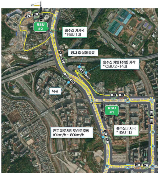
그림 2. 판교제로시티 실 도로 동시 접속 시험 시나리오
