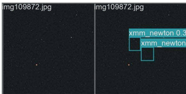
그림 1 YOLOv8s(좌), SpikeYOLO(우)의 실제 객체 탐지 예시
