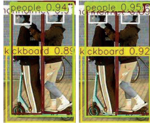
[그림 2] 기존 YOLO 모델 (좌) 및 Spiking YOLO 모델 (우) 객체 검출 결과
