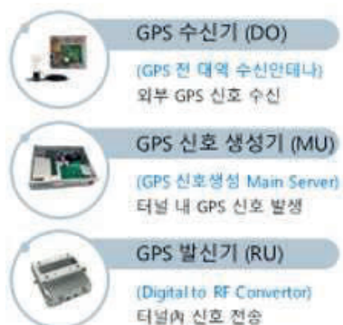
그림1. 터널내 GNSS 시스템 구성 및 결과
