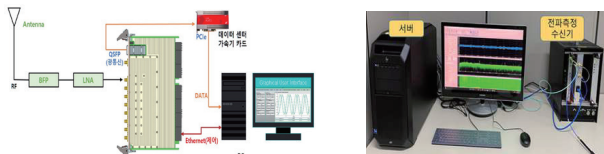
그림 1. 전파사용 측정시스템
