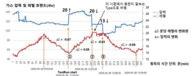
그림 5 용해로-홀딩로 모델 변수 도출 현장 시험
