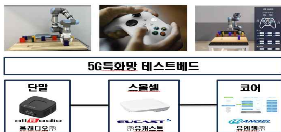
그림1. 5G특화망에서 협동로봇 텔레오퍼레이션 시스템 구성
