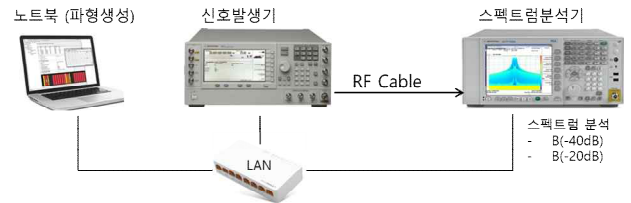
그림1. 레이다 신호 파형 생성 및 분석을 위한 장비 구축
