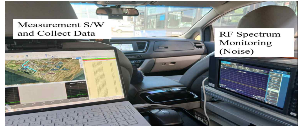
그림 2. Map 기반 실시간 전파잡음 신호 측정(Measurement) S/W 및 RF 스펙트럼(전파잡음) 모니터링 연계 및 구성(내부)
