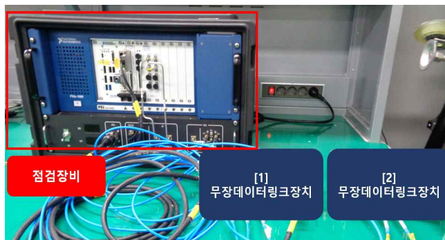
그림 2 다중 점검 시스템 시험 환경 구성
