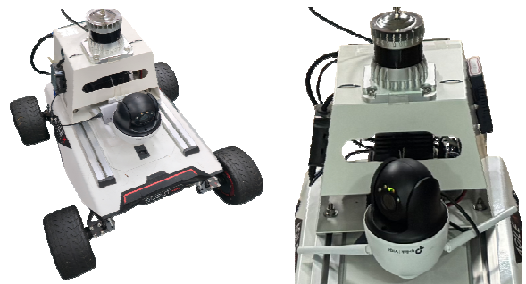
<그림 1 무인 지상 이동체 시스템 및 탑재 센서>
