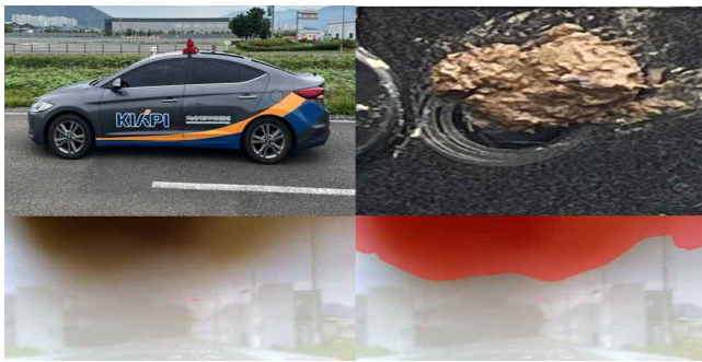
그림 2. 시험 차량 및 카메라 오염 재현·식별 결과
