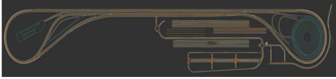
그림 2. 정밀도로지도(지능형자동차부품진흥원 주행시험장) 계층이 사용된다. 경로 계획에는 일반적으로 A*, Dijkstra 알고리즘[4-5] 등의 최적 경로 탐색 알고리즘이 활용된다. 최적 경로 탐색을 통해 출발지와 목적지 간의 차로 중심선 좌표 데이터가 추출된다. 정밀도로지도로부터 추출된 차로 중심선을 지도 서비스 플랫폼에서 반환된 경로 데이터와 연결하면 자율주행 차량이 이동하게 될 경로가 완성된다.
