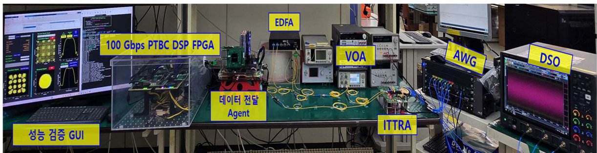
그림 4. 100 Gbps 코히어런트 DSP 실험 셋업 구성
