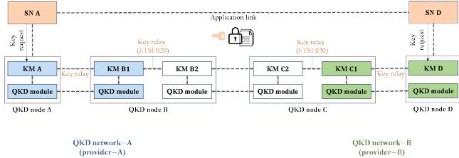
본 논문에서는 해당 구간에 키 전달 요청이 과도하게 발생할 것으로 예상하기 때문에 적응형 양자키 전달 기능을 개발하였다. 적응형 양자키 전달 기능은 사용자의 보안레벨, 양자키관리 시스템의 키 보유량 그리고 환경 구축에 따라 키 전달 시 암호체계를 변경하여 희소성 있는 양자키를 효율적으로 운영하며 보안성까지 확보하는 기능이다. 그림은 적응형 양자키 전달 시스템의 구조이다. 기존 양자키관리 시스템과의 연동은 ETSI QKD 020 표준을 사용하며 상호운용성을 확보하였으며, 키 전달 시 암호체계는 TLS v1.3을 사용한다.
