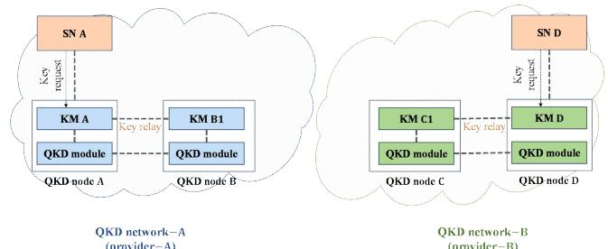
따라서 그림과 같이 이기종 양자암호통신망 연동을 위한 구조를 Trusted-Bridge 양자기관리 시스템을 통해 제안하였으며, 해당 구조를 통해 서로 다른 양자암호통신망에 속한 Service Node(SN)간에 양자암호
