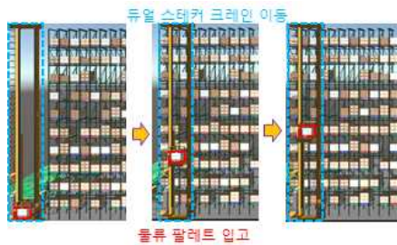
[그림 4] AS/RS 듀얼 스택어 크레인 입고 동작 움직임 3D 시각화 [그림 4]은 AS/RS 듀얼 스택어 크레인 입고 움직임 3D 시각화 프로세스 결과를 나타낸다.
