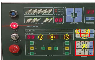
[그림 2] 듀얼 스택커 크레인 제어 패널의 키패드 구조
