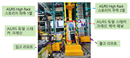
[그림 1] 레거시 AS/RS 듀얼 스택커 크레인 구조
