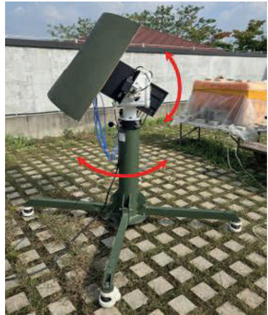
Figure 2 자세변환에 의한 MSAS 위성 가시성 시험
