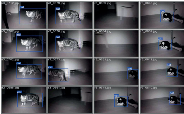
그림 3 적외선(IR) 영상에서 YOLO기반 객체 탐지 결과
