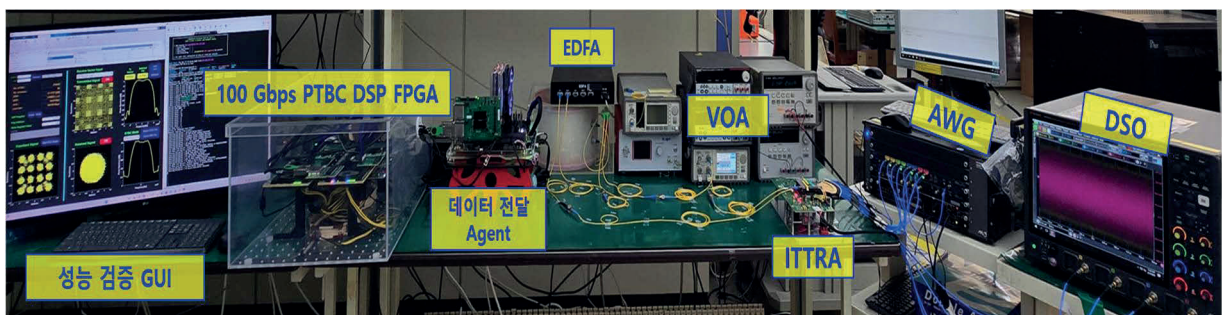
그림 4. 100 Gbps 코히어런트 DSP 실험 셋업 구성
