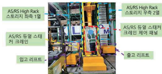
[그림 1] 레거시 AS/RS 듀얼 스택커 크레인 구조
