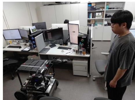
그림 1 단일 RGB 센서를 이용한 사용자 추종 로봇
