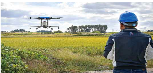
그림 1 UAV를 활용한 농지 방제 예시 Fig1 Examples of Farmland Control Using UAV
