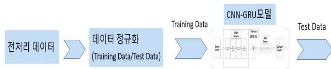
그림 3. CNN-GRU모델 학습 및 테스트
