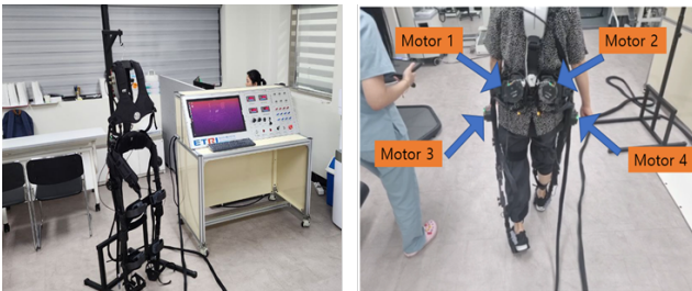
그림 1 실험 환경 및 웨어러블 로봇 착용 예시
